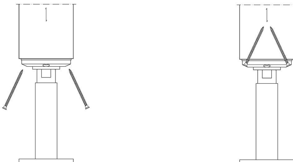
Hinweis: Zur leichteren Montage können Fußplatten mit Gewindestange und Schutzhülse abgeschraubt werden.
